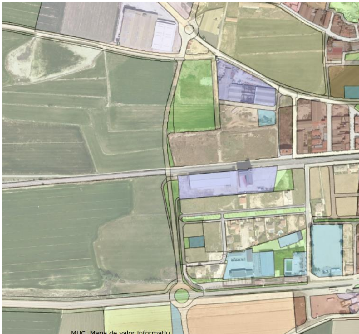
Imatge 110. Planejament previst del nou vial ("ronda oest") entre la N-II i la cooperativa Sant Miquel, així com les rotondes previstes a aquestes cruïlles
