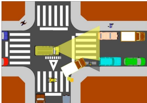
Imatge 127. Ubicació correcta de pas de vianants. Possible ocupació del pas i restricció de la visibilitat.
