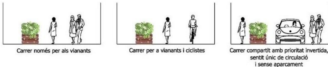
Imatge 121. Possibles seccions per a carrers amb menys de 7 m d'amplada.
